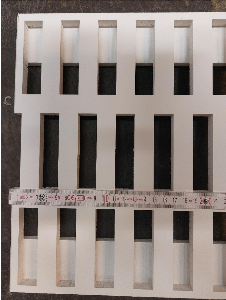
Foto 4 Ansichtsseite Längsvermessung Lochung
